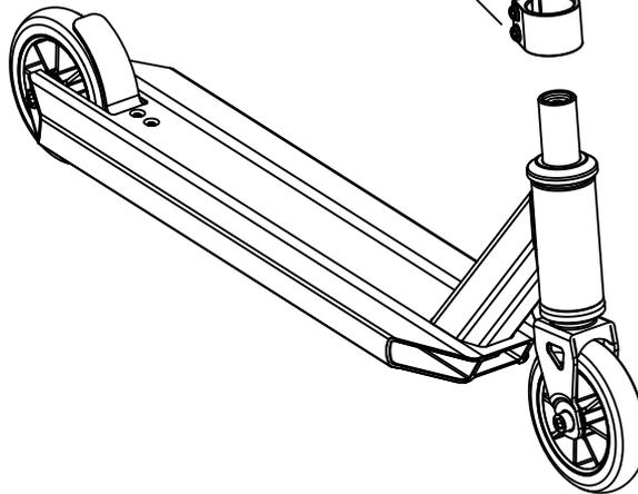
Pousser la t-bar dans la clamp, dans la partie verticale par rapport au plateau. Serrez ensuite les écrous M6x20 à l'aide d'une clé allen 5mm.
