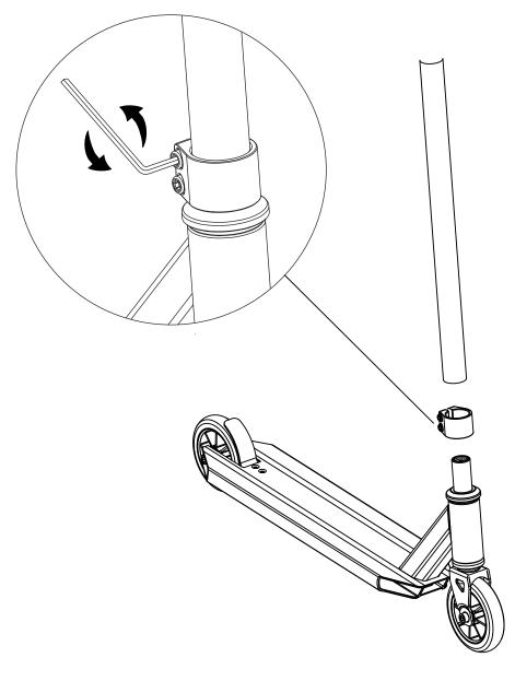
Schieben Sie die Klemme auf das untere Ende der Lenkstange. Stecken Sie die Lenkstange auf die Gabel auf. Richten Sie die Lenkstange im 90° Winkel zum Deck aus und zentrieren die Klemme (offenes Ende zeigt zum Deck hin). Ziehen Sie die Schrauben (M6x20) der Klemme mit dem mitgelieferten 5mm Inbusschlüssel an. Überprüfen Sie alle Schrauben auf einen festen Sitz.
